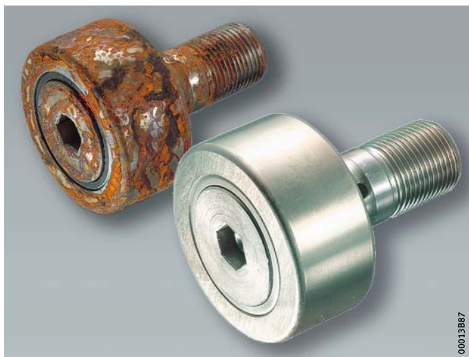
図 25 塩水噴霧試験後の スタッド形トラックローラ コーティングなし、 コーティング済み
