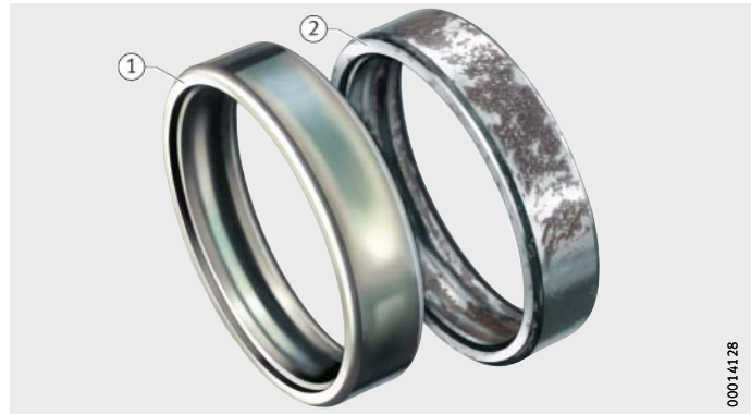
図 11 塩水噴霧試験後の軸受輪
